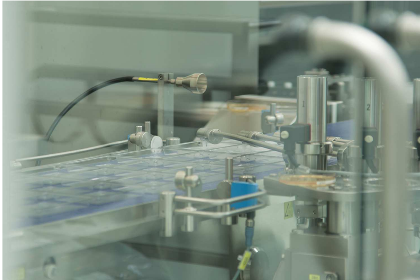
L&R Kollagen-Abfüllanlage; kurz vor der Gefriertrocknung
